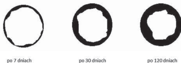
Rys. 6. Zasięg penetracji alkaliów w przecie kompozytowym [4]
