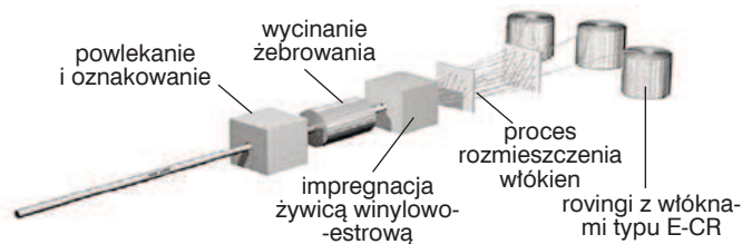
Rys. 1. Schemat procesu wytwarzania prętów kompozytowych metodą pultruzji [M1]
